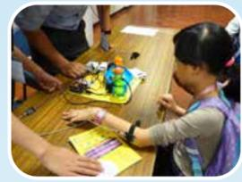
肌電打太鼓是利用皮膚表面貼上電極片收集肌肉收縮的訊號，然後將訊號傳送至電腦控制軟件運作，敲打太鼓。
